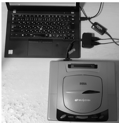
▲ 図 3.1: PC とセガサターンを USB-MIDI を通して繋いだ様子
